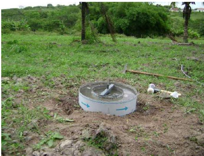
Figura 2. Determinação da velocidade de infiltração da água no solo.
