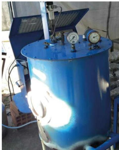
O forno para torrefação da farinha foi construído de aço inox 316, possui 1 m de diâmetro e parede lateral em forma de cilindro com 27 cm de altura. No fundo do forno para torrefação da farinha foi instalada, em formato de serpentina, uma tubulação de cobre por onde escoo o fluido térmico proveniente da unidade absorvedora.
