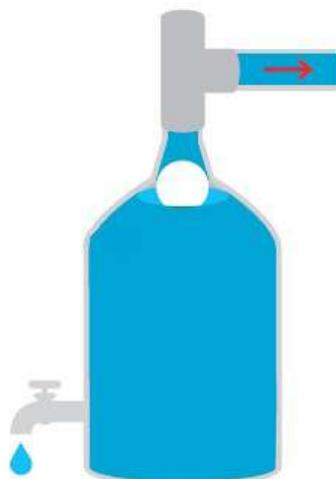
Reservatório com tubos, **Figura 43**, o tubo de descarte deve ser conectado no tubo de queda e pode ser fixado na parede. O tamanho e diâmetro dos tubos dependem da quantidade de água a ser descartada. A água só começa a cair no reservatório quando o volume do tubo estiver totalmente cheio. Devido à sua forma, a
