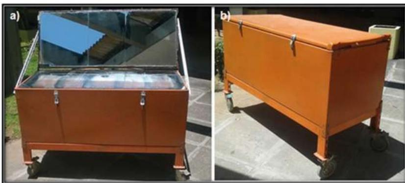
A **Figura 22** apresenta um novo fogão solar tipo caixa com vidro duplo com uma placa absorvente em forma de L com um refletor interno e dois refletores externos. Projetado por ZAFAR et al. (2018). O fogão solar atingiu temperatura interna superior a 130 °C e apresentou um custo de fabricação de R\$500.
