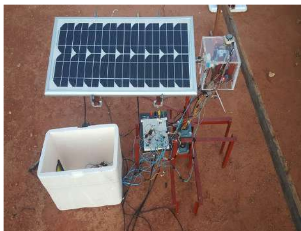
Figura 5: Sistema fotovoltaico móvel.
