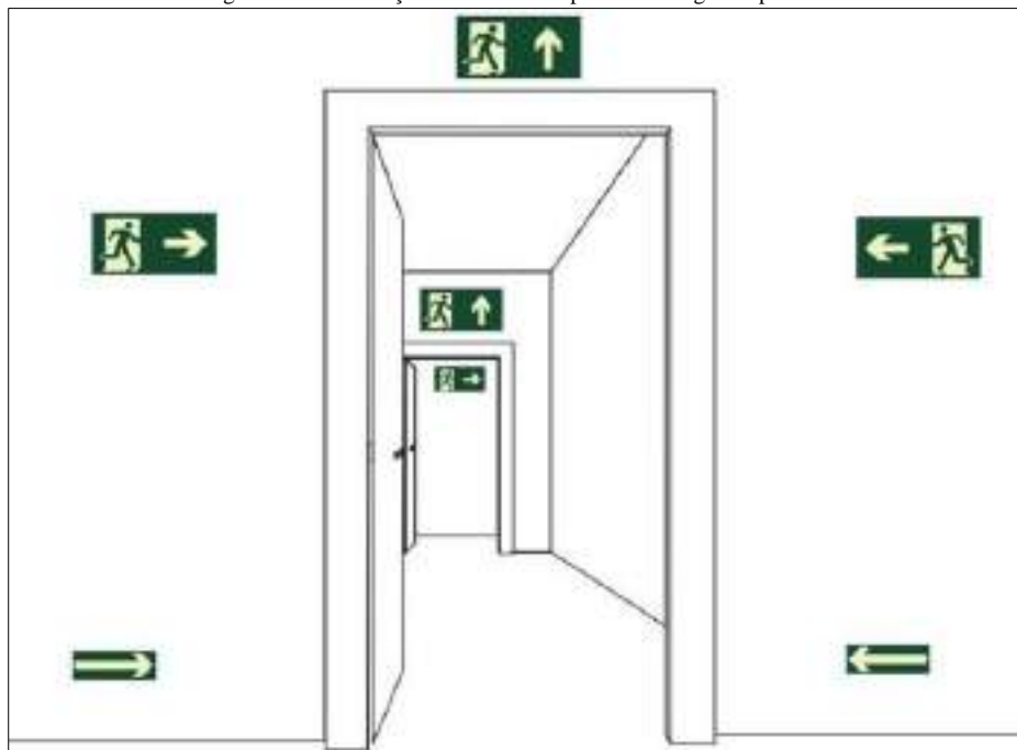
Figura 121. Sinalização de saída sobre paredes e vergas de portas
