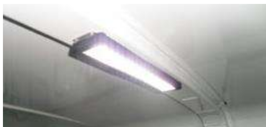
Figura 2: Inspiração para o dispositivo de esterilização, instalado em tetos de veículos de emergência
