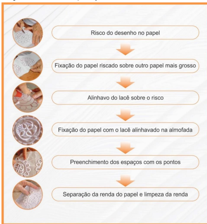
Figura 14. Processo de produção da Renda Irlandesa da ASDEREN
