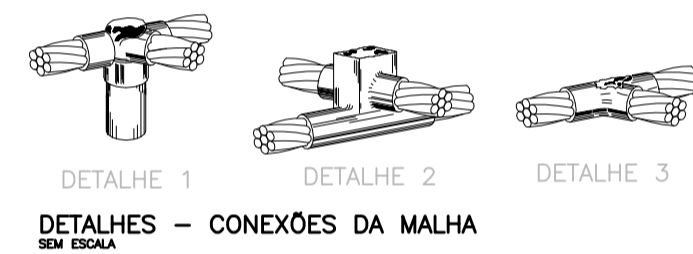
DETALHES - CONEXÕES DA MALHA S/ ESCALA
