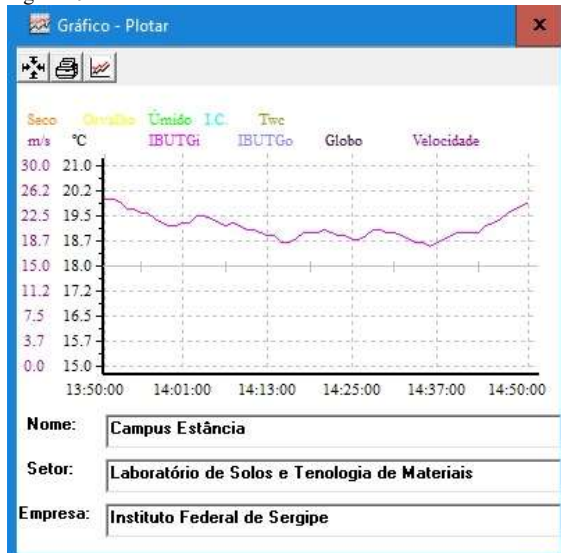
Figura 29. Gráfico com o resultado IBUTG interno do laboratório de Solos e Tecnologia de Materiais
